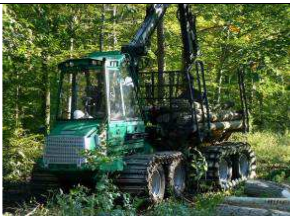
Configuration : synthétiques à l'arrière et métalliques à l'avant + motricité, économique (tracks métalliques moins chers) - interdiction d'aller sur piste Porteur Gremo 1050 F : 12 T à vide, 10,5 T de charge.
