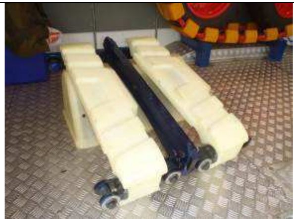
Accessoire « accroche GRIP » : barrette métallique pour circulation sur neige ou pour les terrains pentus.
