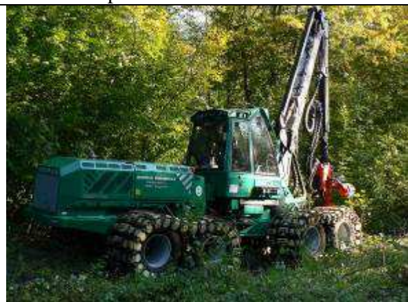
Configuration : tout synthétique + moins lourd (par rapport à des tracks métalliques), circulation sur piste Machine de bûcheronnage Gremo 1050 H : 14,7 T à vide.
